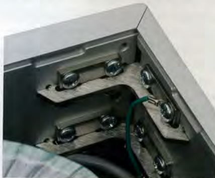
Die Gehäuseplanken sind mit soliden Winkeln verblockt (o.). Die Mini-Tasten auf der Oberseite des IPS-3 steuern Grundfunktionen. Komfortabler geht's über die beleuchtete Fernbedienung
