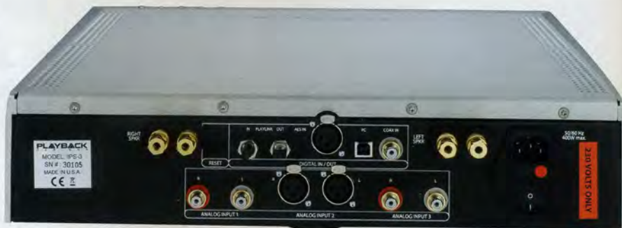
Je drei digitale und analoge Eingänge plus spezielle Schnittstellen für andere Digitalgeräte des Herstellers und ein Paar Boxenklemmen pro Kanal – der IPS-3 outet sich als Purist
